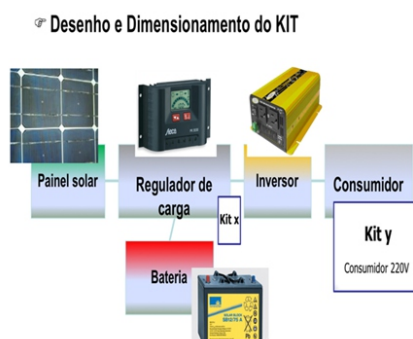
Figura 29. Kit de produção de energia solar
